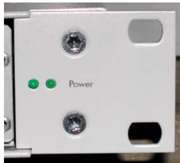
Abb2: Befestigungsflasche mit Anzeigen für „48V-PoE Spannung“ und „5V-Power“
